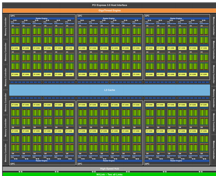
图10.4.8: NVIDIA Turing 架构（图片由英伟达提供）
